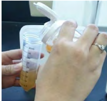
Pour 20ml of the supernatant to a centrifugal tube.
